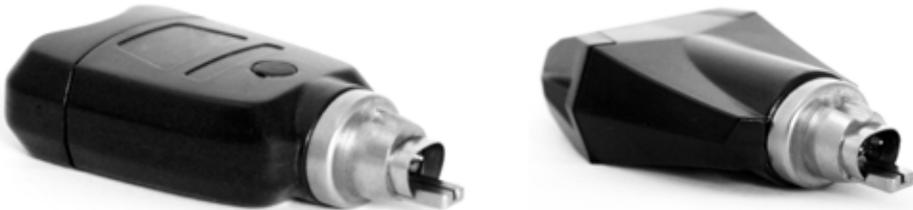
Cuando la llave entra en contacto con la cerradura electrónica (sin batería), la llave transmite energía a la cerradura para que se active. La llave guarda el registro de quién ha abierto (usuario), cuándo (día, mes, año y hora) y dónde (cerradura).
